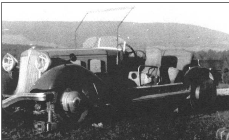
Autowinde der „Stutz“ mit Tachometer zum Schätzen der Seilgeschwindigkeit, Schutzvorrichtungen: keine besonderen; Schleppseil: Länge 900 m, Geschenk an die Zwingner-Segelflieger von einem Max Ehrenzweig.
